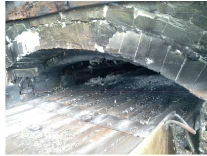
Состояние футеровки после 18 месяцев эксплуатации
